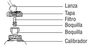
Afirme la lanza en la posición normal de trabajo y pulverice del recipiente hasta cubrir el área correspondiente a 25 m<sup>2</sup>. Mantenga el recipiente en el nivel y haga la lectura. El nivel del líquido indicará el volumen en la escala correspondiente. Vacíe el recipiente y repita la operación. Obtendrá el promedio de dos o más mediciones
