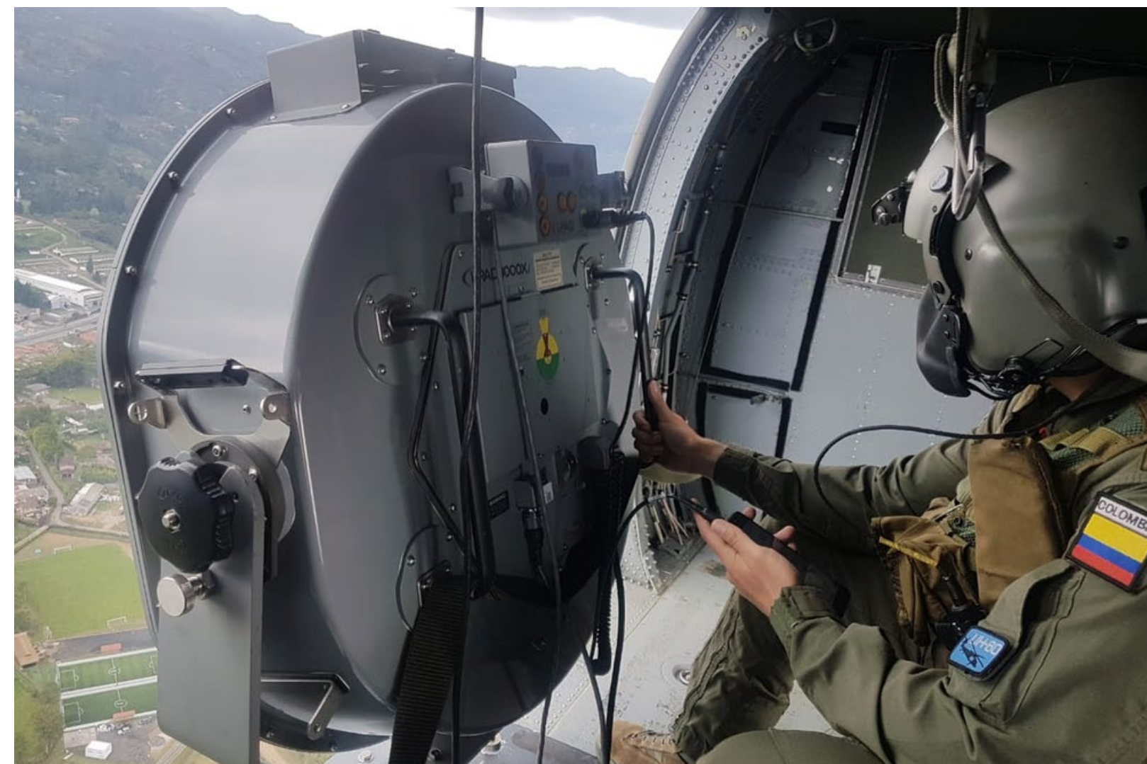
Fabricación de Montantes de equipo perifoneo
