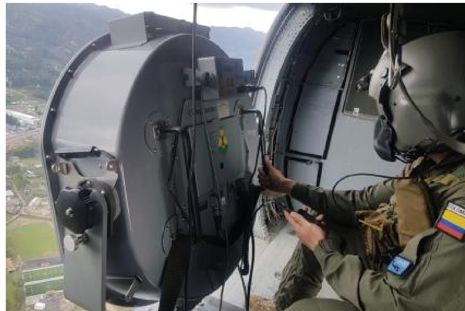
Fabricación de Montantes de equipo perifoneo
